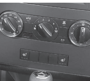
Klimaanlage und Umluftschalter
