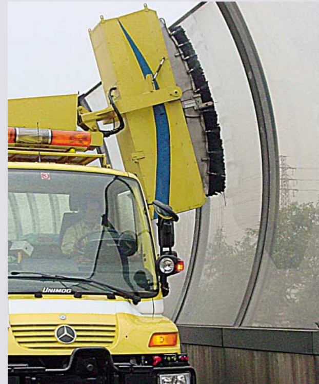
Hat den Dreh raus: der Unimog U 400 mit gebogener, rotierender Bürste
