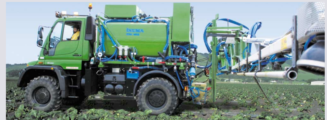
Angetrieben wird die Spritze über die Fahrzeughydraulik des Unimog U 500
