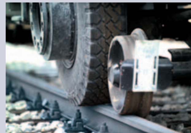
Immer auf der richtigen Spur: der Unimog U 400 mit Spezialbereifung und Zwihehoff-Zagro-Technik
