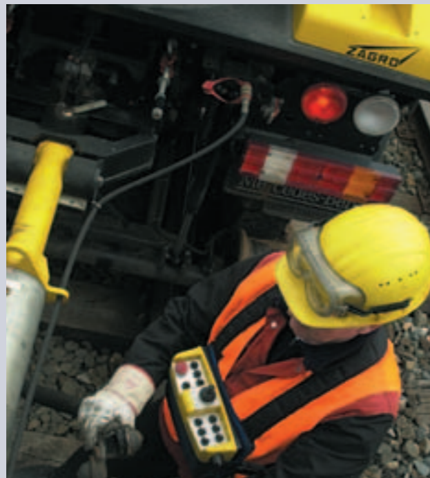
„Safety first“: Hochleistungs-Waggonbremsanlage des Unimog-Rangierers
