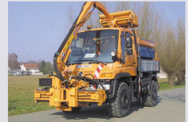
Transportstellung: Der Ausleger ruht auf dem Streuautomaten
